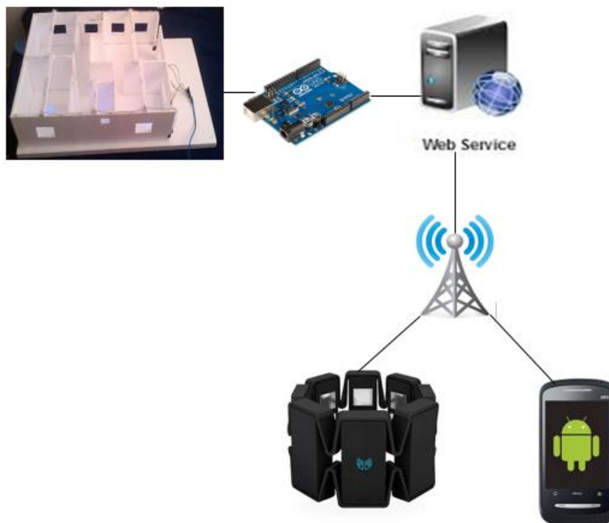
Figura 3 - Visão simples da arquitetura da aplicação Fonte: produção do próprio autor.
