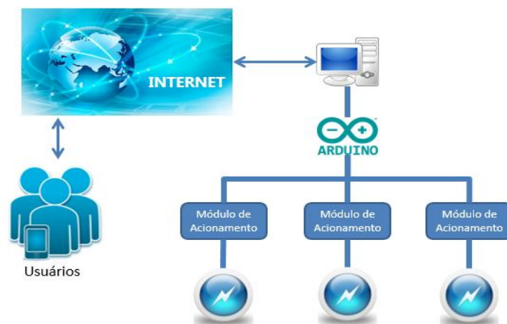
Figura 4 - Arquitetura Arduino com comunicação serial. Fonte: produção do próprio autor
