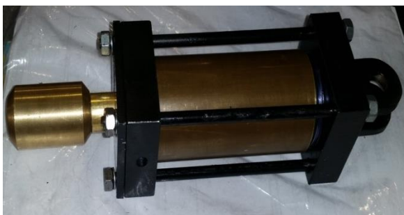
Figura 7: Atuador pneumático produzido durante o estudo Fonte: Elaboração dos autores (2019)
