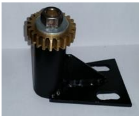
Figura 6: Conjunto de transmissão produzido durante o estudo Fonte: Elaboração dos autores (2019)
