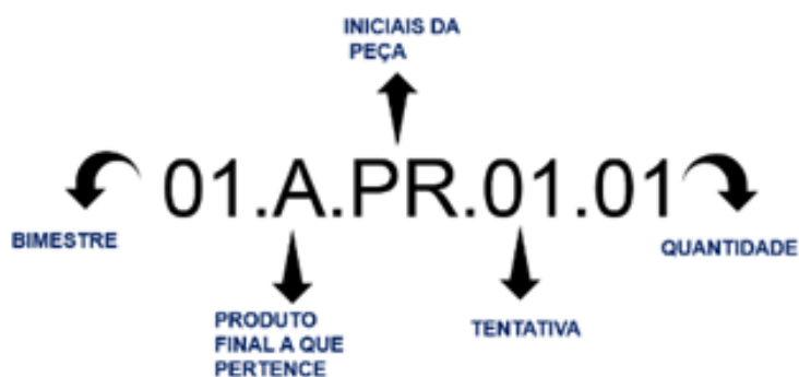
Figura 3: Exemplo de codificação de peça Fonte: elaboração dos autores (2019)
