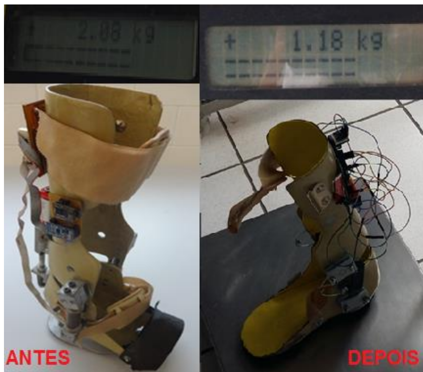
Figura 5 - Pesagem do sistema anterior em comparação com o novo peso obtido.
