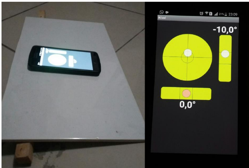
Figura 6 – Testes para verificar a angulação do plano.
