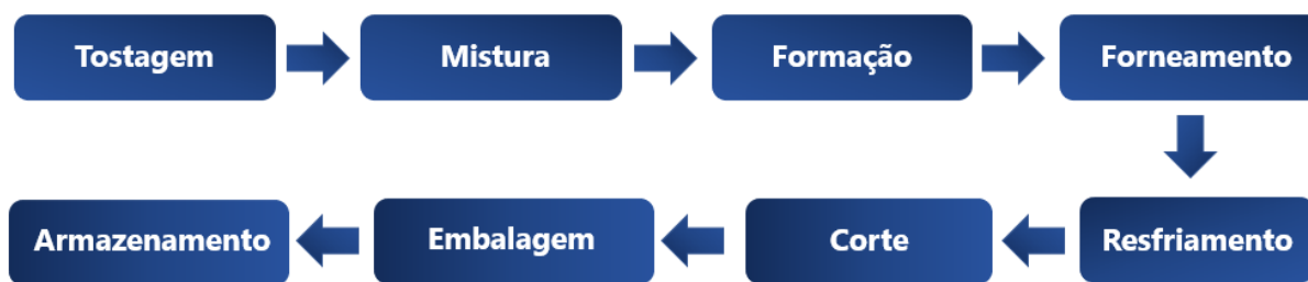
Figura 1 - Fluxograma de produção de barrinhas de cereais com utilização de biomassa da banana verde. Fonte: adaptado de Santos (2016).
