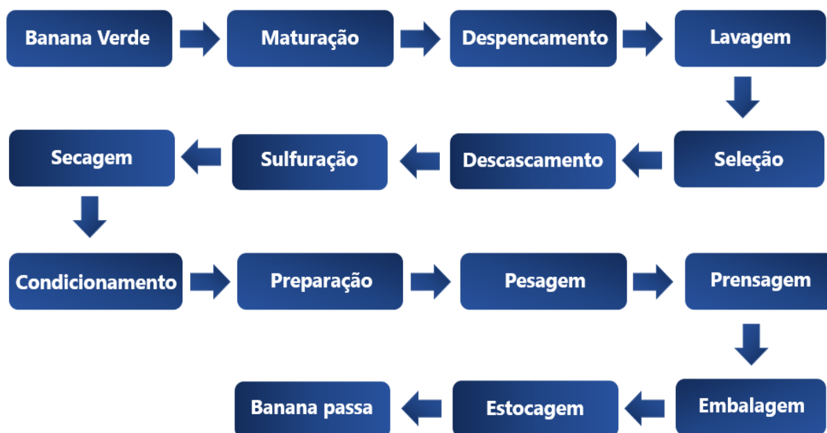
Figura 2 - Fluxograma de produção de banana-passa. Fonte: adaptado de STRINGHETA et al. (2003).
