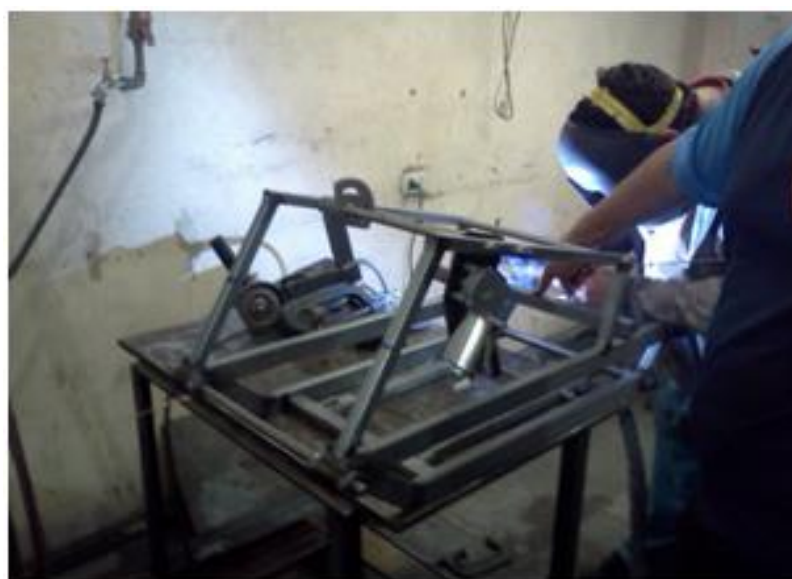
Figura 3 - Montagem e soldagem. Fonte: elaboração dos autores (2021).
