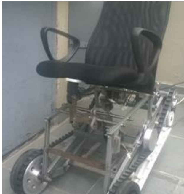
Figura 8 - Cadeira em testes com a inclinação aprovada. Fonte: elaboração dos autores (2021).
