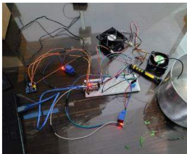
Figura 18 – Funcionamento das ventoinhas e da bomba em conjunto com os DHT11
