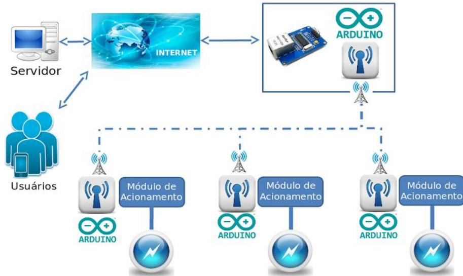
Figura 5 - Arquitetura Arduino com dispositivo *wireless*.
