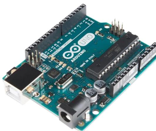
Figura 2: Placa Arduino (UNO R3) utilizada no projeto.
