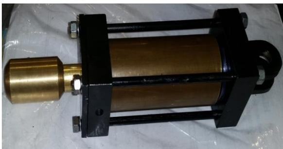
Figura 7: Atuador pneumático produzido durante o estudo
